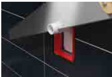
7. Na označené úrovni odříznout pilou
